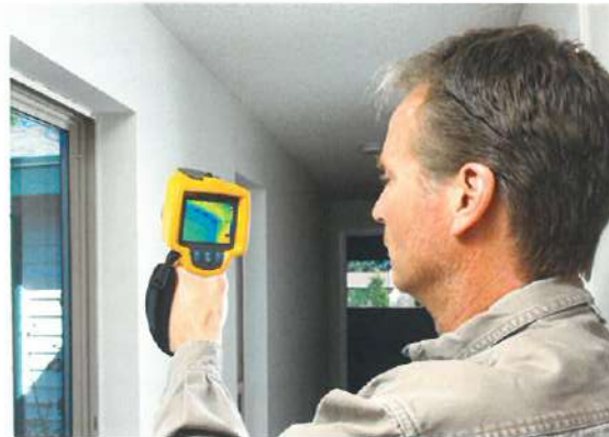
Die Wärmebildkamera zeigt, wo Temperaturunterschiede bestehen, die einen Schimmelpilzbefall begünstigen können.
